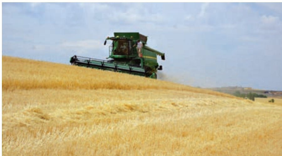
Foto 4. La cosechadora John Deere T560i está dotada con el sistema Hillmaster de compensación de pendientes.
