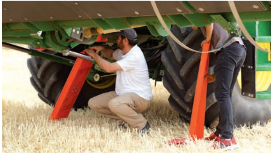
Foto 6A. Colocación de las cajas de ensayo bajo el cabezal.
